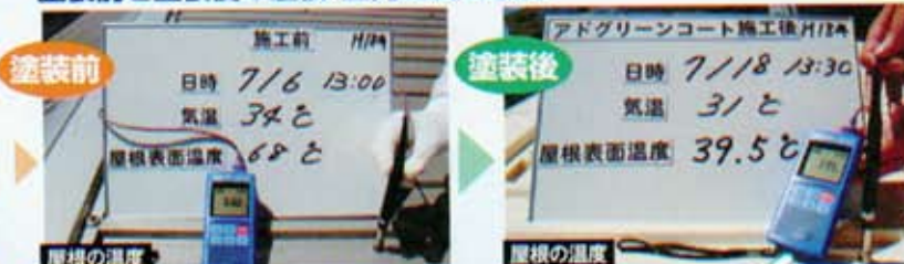
塗装前と塗装後の屋根・室内温度の比較
